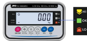
バック詰め作業（少ない・ちょうどよい・多い）ランク分け作業 決められた量さに対して『少ない（LO）・ちょうど良い（OK）・多い（HI）』という判断をコンパレータライトで直感的に判断できることで作業効率が大幅に向上します。 その種の範囲（上下下限値）は最大10個まで登録が可能です。
