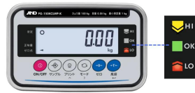
バック詰め作業（少ない・ちょうどよい・多い）ランク分け作業 決められた量さに対して『少ない（LO）・ちょうど良い（OK）・多い（HI）』という判断をコンパレータライトで直感的に判断できることで作業効率が大幅に向上します。 その種の範囲（上下限值）は最大10個まで登録が可能です。
