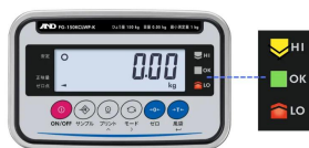
バック詰め作業（少ない・ちょうどよい・多い）ランク分け作業 決められた量さに対して 『少ない（LO）・ちょうどよい（OK）・多い（HI）』という 判断をコンパレータライトで直感的に判断することで作業効率を 大幅に向上します。 その種の範囲（上下閾値）は最大10個まで登録が可能です。
