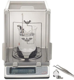
写真は、比重測定キットをはかりに取付けたイメージです。
