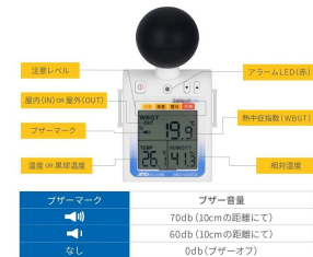
株式会社 エー・アンド・デイ 画像は、各部名称の概要です。
