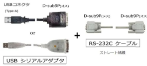
USB シリアル変換キット P/N: S321-62520-45
