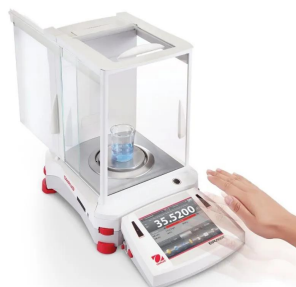
写真は、非接触で風防を開閉するイメージです。
